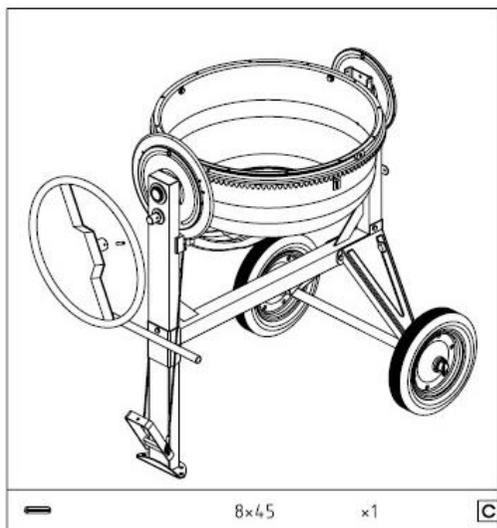
Наденьте поворотное колесо механизма опрокидывания на штифт механизма опрокидывания. Вставьте стопорную втулку в отверстие, используйте молоток для фиксации втулки.
