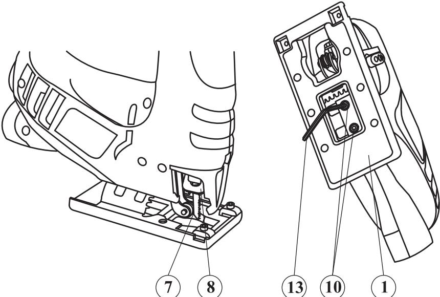
8. Фиксатор пилкодержателя
