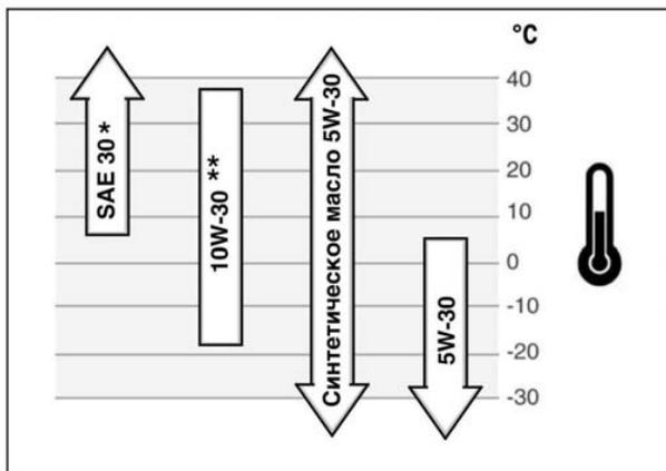
Самым универсальным по SAE для теплого времени года будет масло 10W30. При эксплуатации генератора в холодное время года заливаем масла из нижней строки, обращая внимание на маркировку SJ или SL, – это наиболее современные и качественные масла для бензиновых двигателей.
