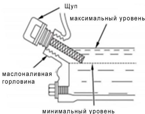
Перед началом работы проверьте уровень масла в картере двигателя. Уровень масла определяется по указательному стержню на пробке заливных отверстий картера двигателя (двигатель должен быть установлен **строго горизонтально**). При не завернутой пробке уровень масла должен находиться в насеченной зоне между минимальным и максимальным уровнем (см. рисунок).
