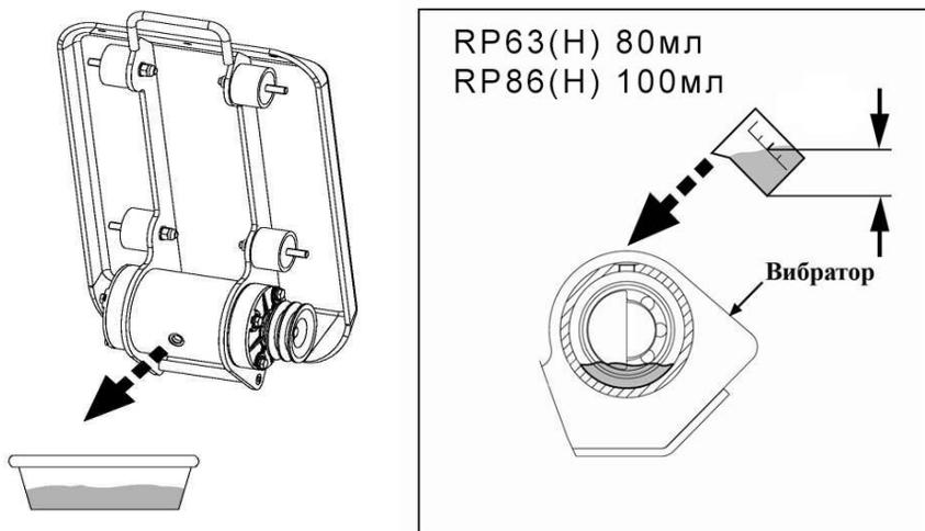
Производить замену масла в вибраторе следует через каждые 200 часов работы. Следите чтобы уровень масла был в пределах  $80\text{мл} \pm 5\%$  для RP63(H) и  $100\text{мл} \pm 5\%$  RP86(H). Превышение количества масла может привести к повышенному давлению и температуре в вибромеханизме.
