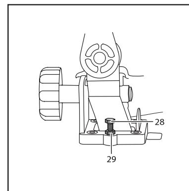
б) Регулировка угла наклона пиления 45°
