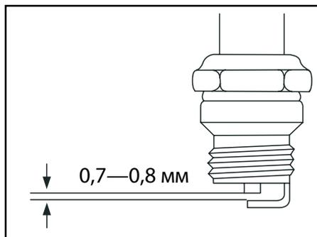
Зазор между электродами должен составлять 0,7-0,8 мм.
